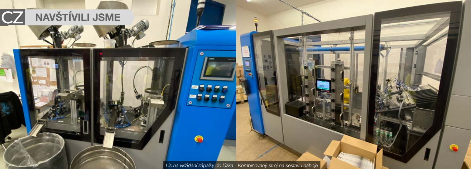
Lis na vkládání zápalky do lůžka Kombinovaný stroj na sestavu náboje
