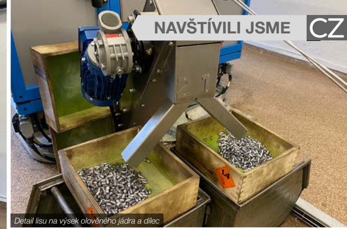
Detail lisu na výsek olověného jádra a dílec
